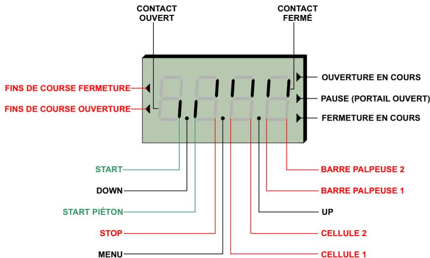
**NOTE :** Les contacts de sécurités peuvent être désactivés dans la programmation en mettant la valeur des paramètres concernés sur "no". Dans ce cas, il n'est pas nécessaire de ponter les contacts de sécurités sur l'armoire. Le segment de l'afficheur correspondant reste cependant vers le bas.
