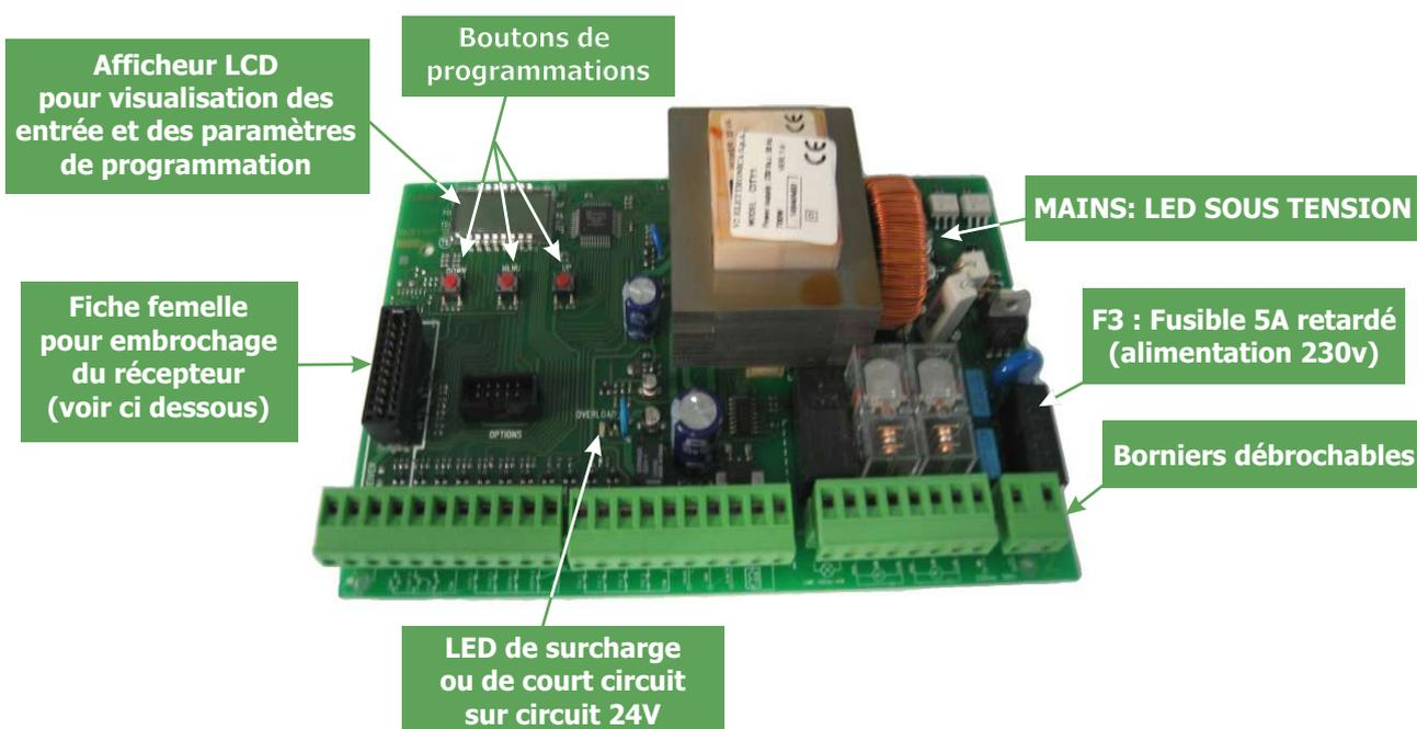
**NOTE :** La protection du circuit 24V est assurée par un fusible électronique à réarmement automatique. En cas de surcharge ou de court circuit, la led OVERLOAD s'allume et le circuit 24V est coupé. Quelques minutes après la disparition du défaut, la led OVERLOAD s'éteint, la platine est prête à fonctionner.
